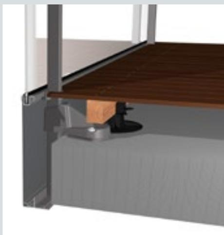
La garde au sol devient invisible et la mise en place d'une terrasse rapportée se fait en toute discrétion grâce à l'alignement parfait avec le profil bas.
